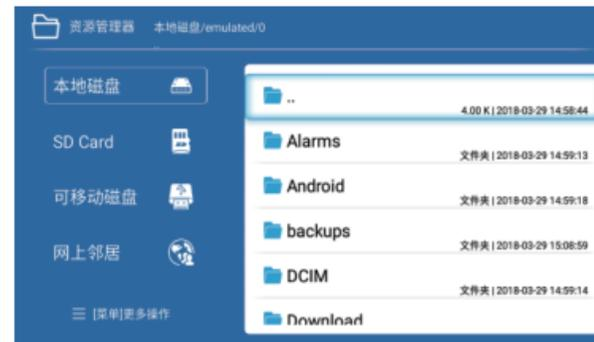
插入U盘硬盘皆可在主界面 - 资源管理器下的可移动磁盘中读取（U盘最大支持32GB，硬盘最大支持1T）。打开U盘中的内容，操作方式，比如在资源管理器中找到需要打开的PPT，然后点击文档打开即可。
