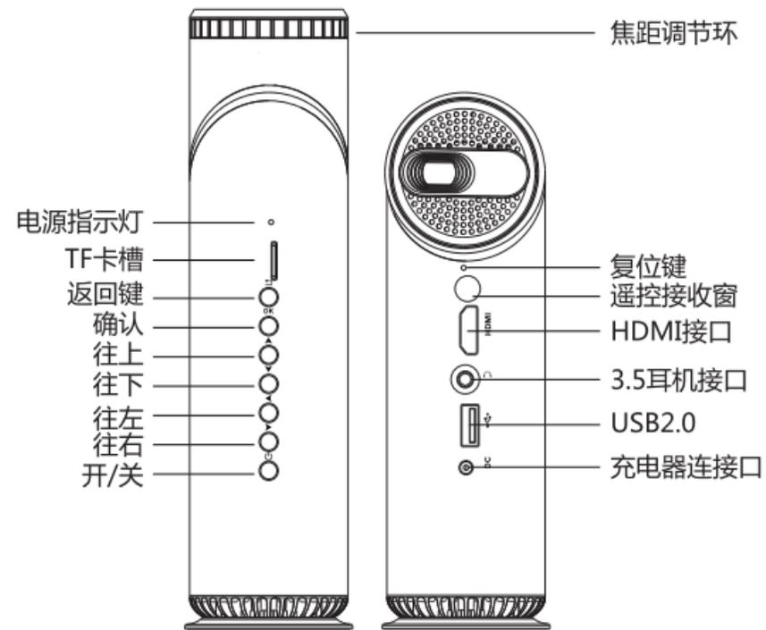
清晰度调试：通过旋转焦距调节环，根据距离调试到最佳清晰度。该焦距调节器为无极设计，调节时需轻轻前后微调旋转，直至微调到屏幕清晰为止。
